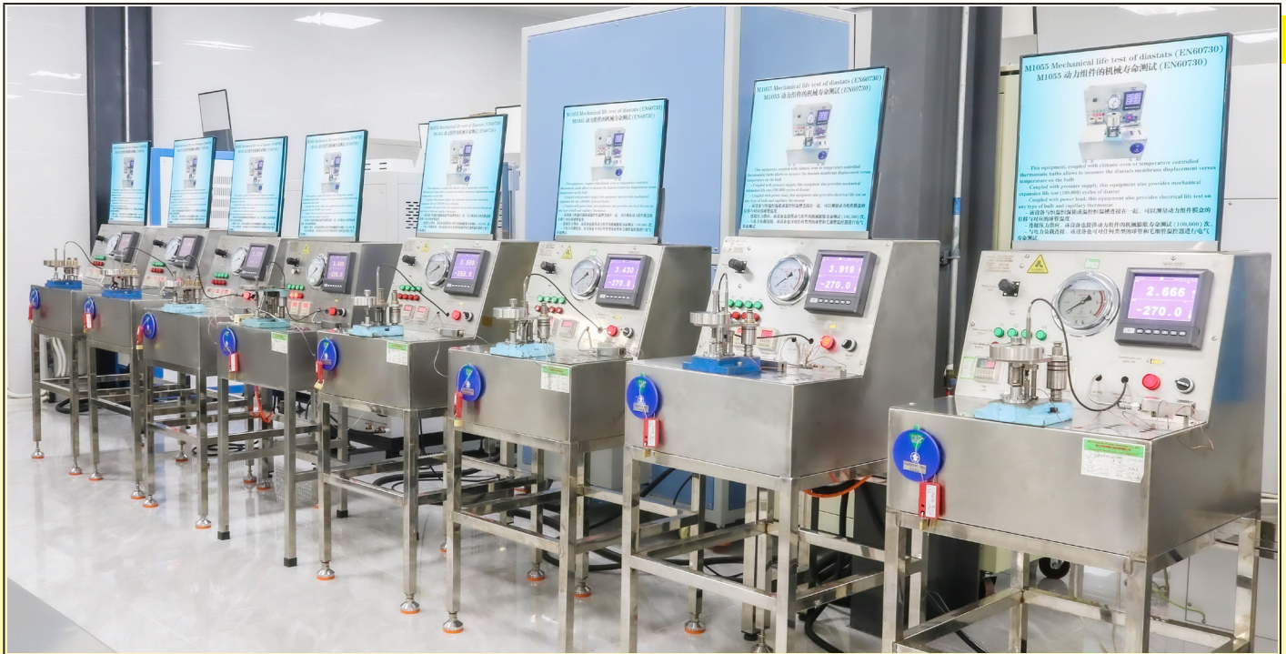
Reihe von mechanischen Lebensdauertestgeräten für Diastate Jedes Gerät ist mit einem Datenrekorder ausgestattet, der die Testparameter und die Anzahl der Zyklen aufzeichnet. (Ultimheat Labor)
